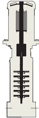
Eje bomba acoplado a eje motor
