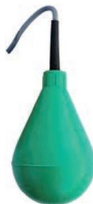
Están indicados para la instalación en depósitos de grandes dimensiones, gracias a su amplia carrera, y son idóneos para el uso con líquidos cargados. Son de tipo multicontacto, por lo que pueden conectarse en configuración "normalmente cerrado" o "normalmente abierto", es decir, tanto con función de llenado como de vaciado.
